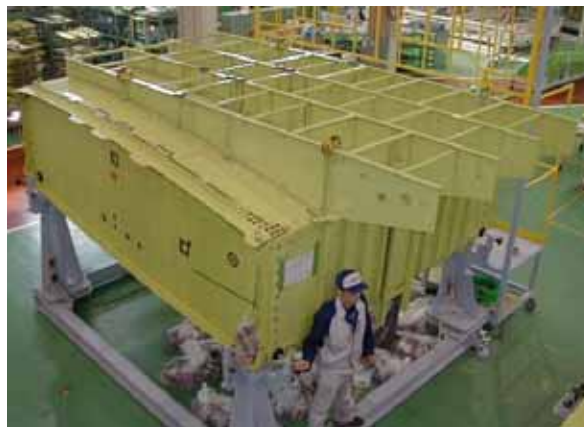
次期固定翼哨戒機 中央翼（全機静強度試験機用）
